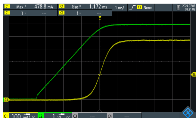
Figure 6. Default PID ( K_p=0.16\text{ \%}/A , T_i=5.5E-05\text{ s} , T_d=1E-05\text{ s} , Slope Limit = 10 A/s)
